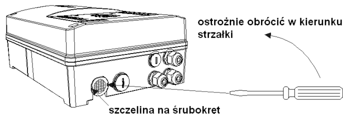
Rys. 19 Usuwanie zaślepki rury wylotu powietrza
